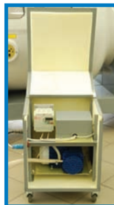
Насосный блок (при наличии гипобарического режима) имеет габариты 0,48х0,49х0,57 м
