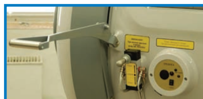
Ручка байонетного замка используется только как аварийная при отсутствии давления в сети питания
