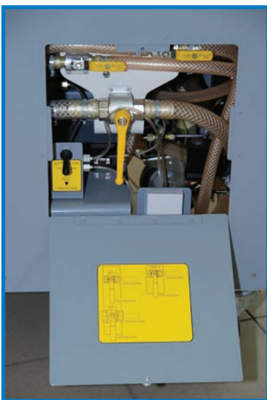
В нижней части барокомплекса расположены шаровые краны переключения режимов (гипербария/гипобария)
